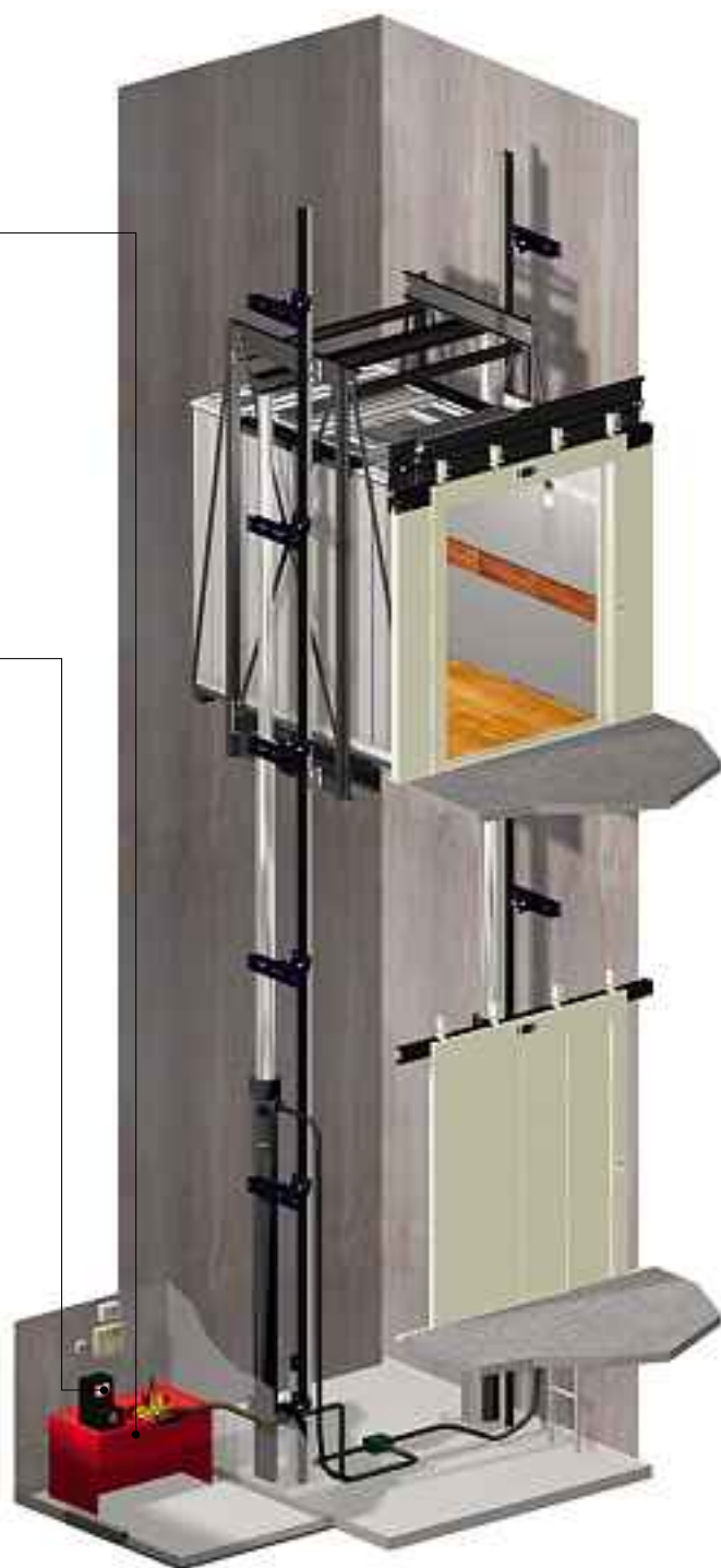
Sistema de tracção hidráulico de dois êmbolos
