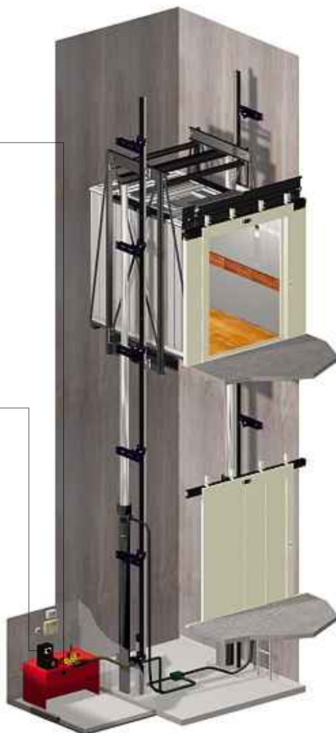
Sistema de tracção hidráulico de dois êmbolos
