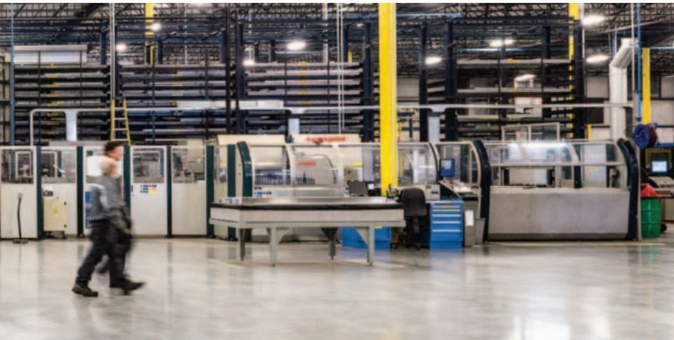
Photo à gauche : Une machine géante Salvagnini fabrique des composantes d'ascenseur à partir de feuilles de métal. Considérée comme un outil de production allégée, la machine Salvagnini réduit les coûts de fabrication en éliminant les pertes et offre la possibilité de produire une variété de produits en petits lots en vue d'une livraison dans les temps. Photo ci-dessous, à gauche : La chaîne de peinture en poudre donne aux pièces d'ascenseur un fini coloré. Photo ci-dessous, au centre : Des panneaux solaires photovoltaïques fournissent la moitié de l'énergie consommée annuellement par l'usine de Hanover. Photo ci-dessous, à droite : Une borne de recharge pour véhicule électrique sur les lieux de l'usine de Schindler, à Hanover.
