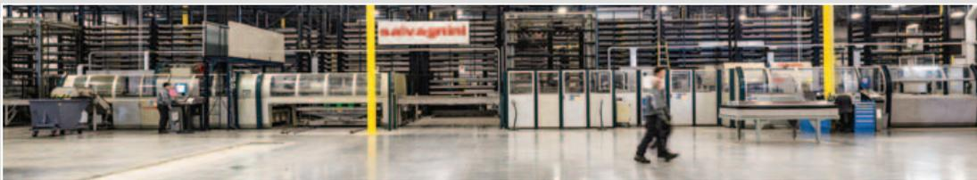
Le **système de fabrication haute performance et versatile Salvagnini** est conçu pour perforer, tailler et plier le métal en feuilles, produisant des composants d'ascenseur de qualité, avec précision.
