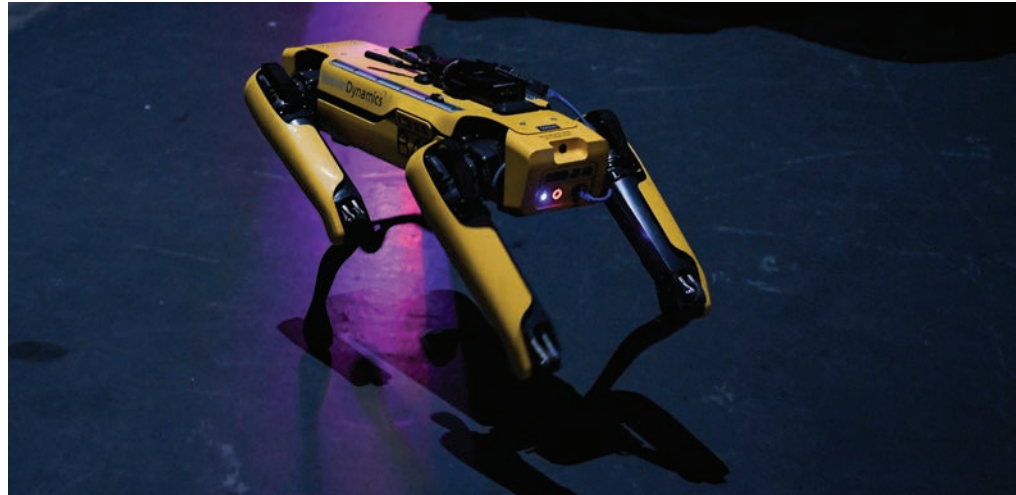
图 1. 传统建筑作业的机器人化可以延伸到结构装配（左上）、重复行为 [如铺砖（右上）和抹灰（左下）]，以及对危险或复合环境的检查，这也是 Spot 机器人一种可能的用途（右下）。这种地面机器人能够在工作环境中自主导航、携带检测设备并收集关键数据。
