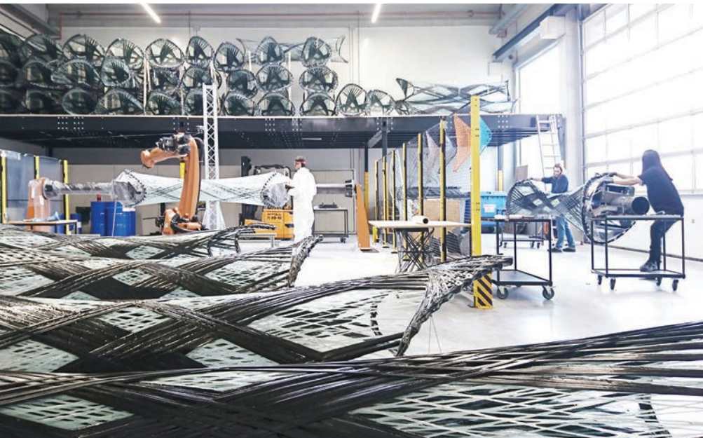
图 2. 在斯图加特大学计算设计与建筑研究所 BUGA 纤维展馆, 可以看到使用拉伸纤维和树脂进行纤维缠绕的增材技术。© 斯图加特大学 ICD/ITKE
