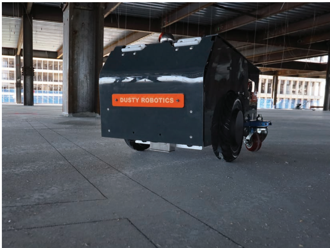
图 4. Dusty Robotics 公司研发的 FieldPrinter 实现了机器人布局自动化，将 BIM 数据引入建筑现场。 © Dusty Robotics
