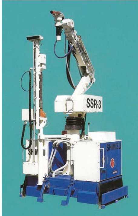
图 9. 这些单项任务机器人由 Shimizu 于 20 世纪 80 年代开发，执行钢结构防火喷涂等活动。© Shimizu Corp.
