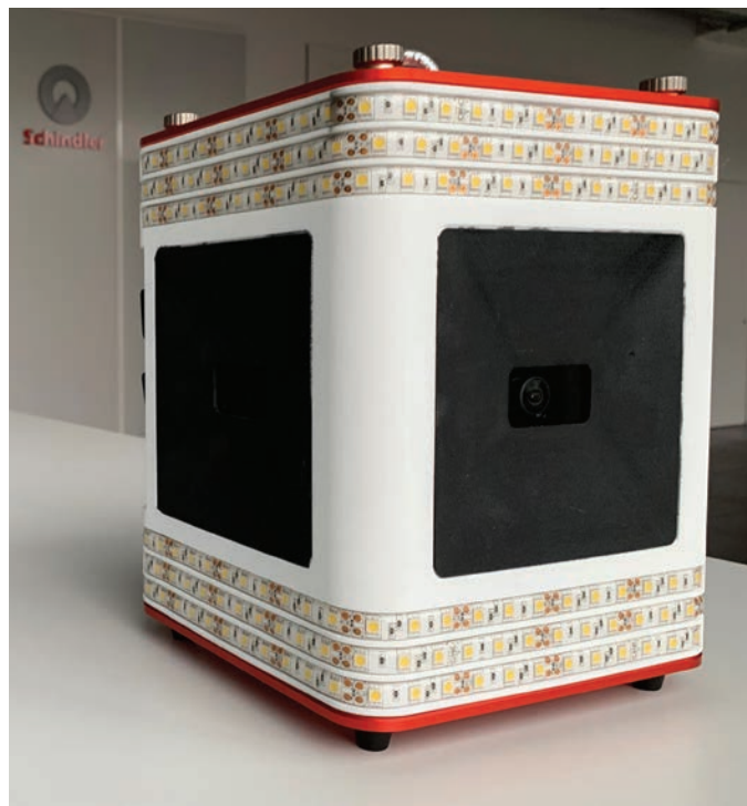
图 2. 摄像单元由四台摄像机、LED 照明系统和一台用于数据处理的计算机组成。
