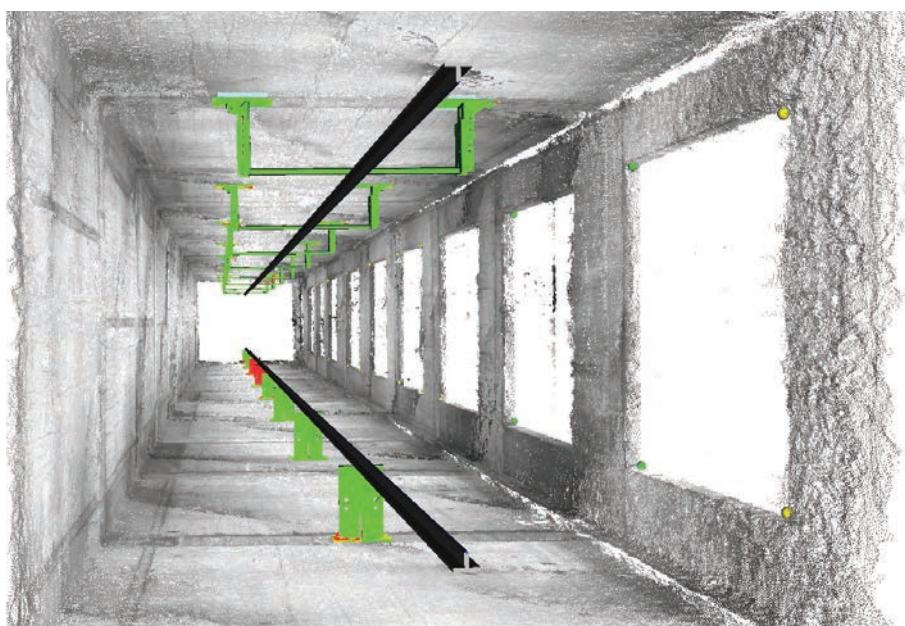
图 10. 完整安装虚拟电梯后的井道。支架呈红色的部分，表示存在公差问题。
