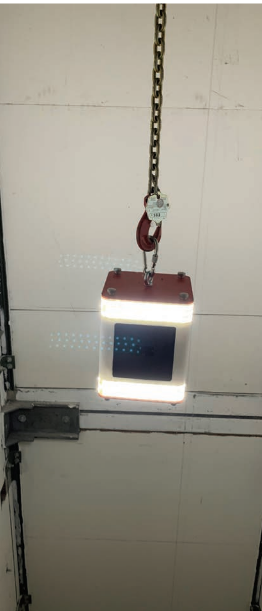
图 3. 正在井道中使用的摄像机单元。
