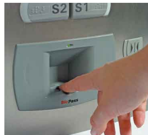
O usuário aciona a Unidade de Leitura Biométrica na cabina. Se reconhecido pelo sistema, o BioPass libera os andares previamente cadastrados.
