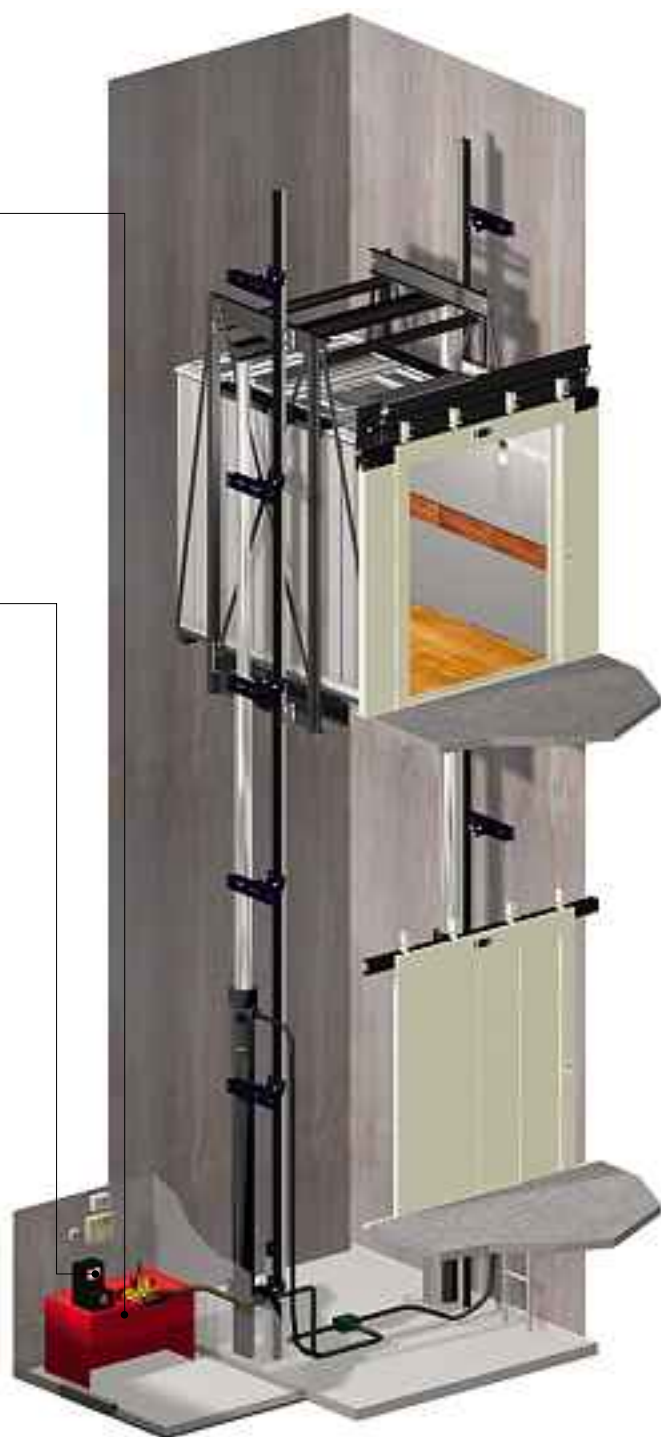
Sistema de tracção hidráulico de dois êmbolos
