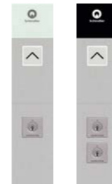
Etagentableau (LOP), mechanische Tasten, mit Schlüsselschalter*, 65 x 290 mm (teileingelassen im Türrahmen), 90 x 290 mm (teileingelassen im Mauerkasten)
